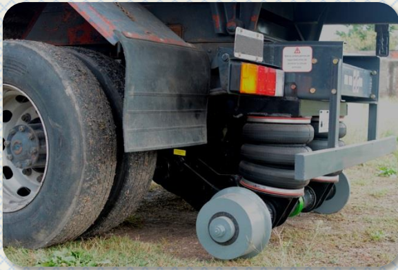
Equipo Hi-Rail instalado en camión Volkswagen 9-150
