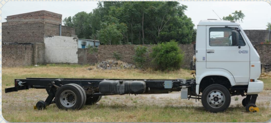
Equipo Hi-Rail instalado en camión Volkswagen 9-150
